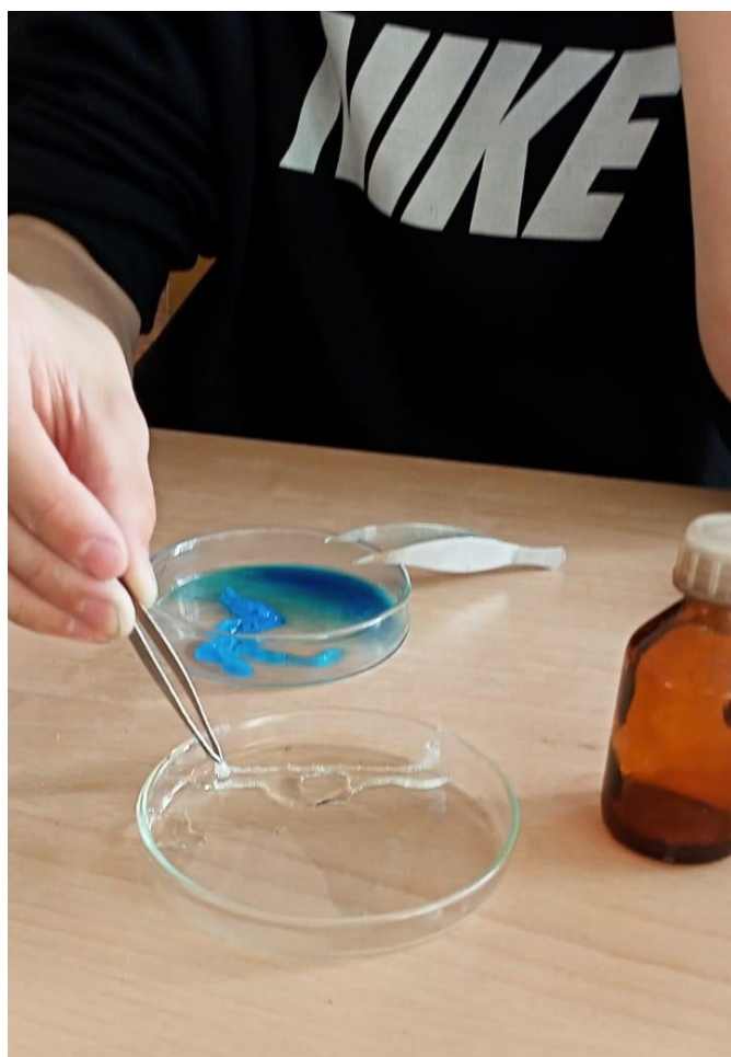
Фото 10-11. Получение волокна. Пропускание прядильного раствора через 10-процентный раствор серной кислоты \text{H}_2\text{SO}_4 . (второй способ)
