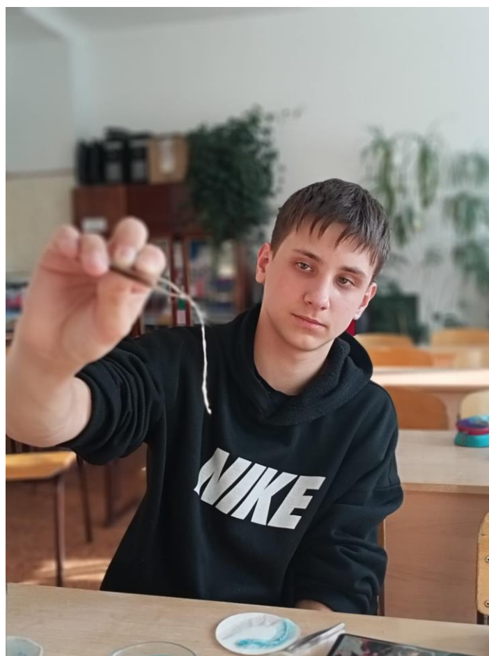
Фото 10-11. Получение волокна. Пропускание прядильного раствора через 10-процентный раствор серной кислоты \text{H}_2\text{SO}_4 . (второй способ)
